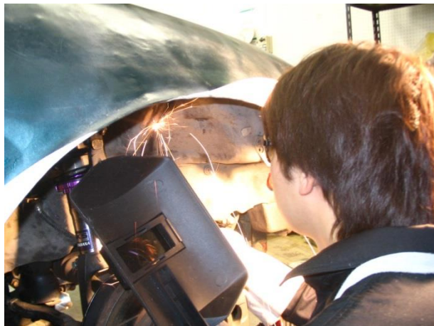
’06ガレージ 剛性の落ちたモノコックを復活させるため、ホイールハウスのスポット増しを実施。
