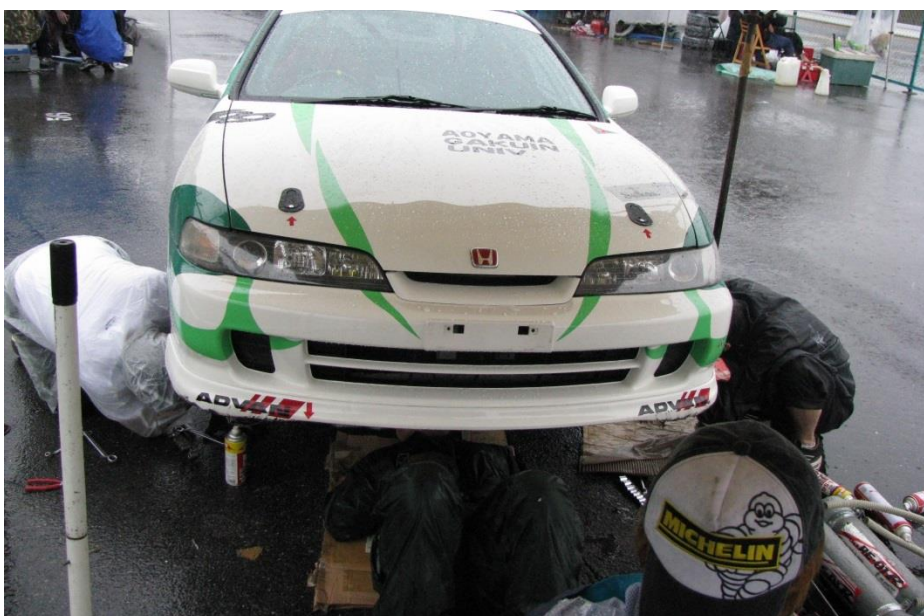
’08全日G(鈴鹿) 本大会で新生AGACで初めて、ドライブシャフトの寿命管理を実施。前日練習後にその場でリビルド品へ交換し、本戦へ臨む。
