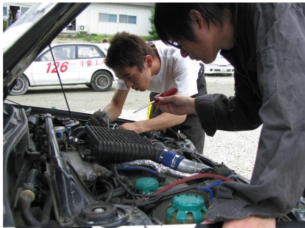
’08全日D(丸和) パワートレインは無改造。FC用インタークーラーは敢えて使わず、純正を信じる。
