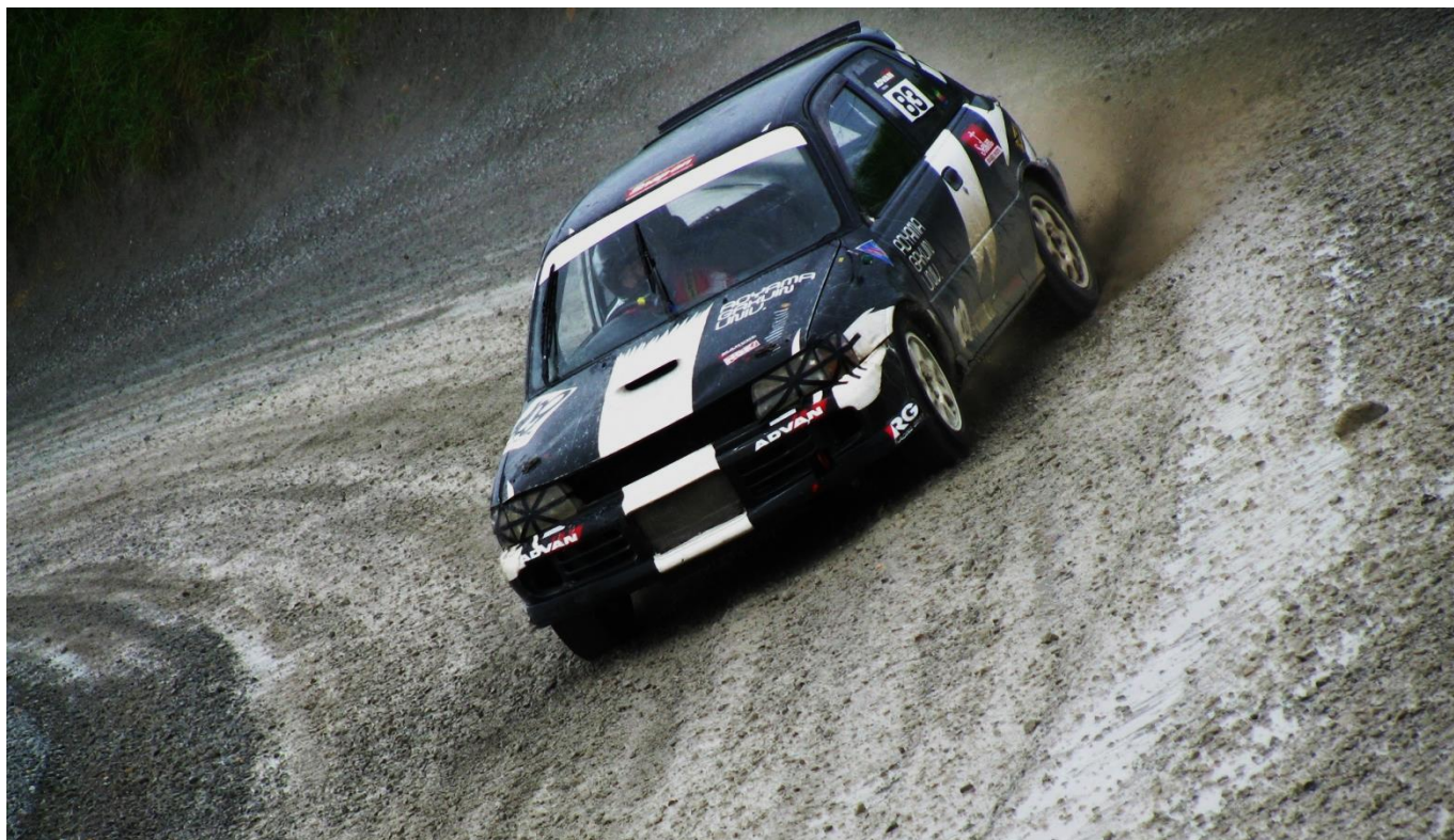
’09全日D(TSタカタ) ’08全日戦でポテンシャルを見せたことにより、ボデー歪み改修を実施して’09シーズンも続投。左右のホイールベースが違ったままだが、大幅にハンドリングが改善。団体戦で上位進出の兆し。
