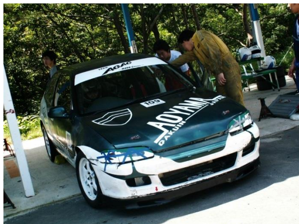
’06エビス合宿 本合宿直前、7Lの超小型燃料タンクへ交換。運動性能アップを図った。
