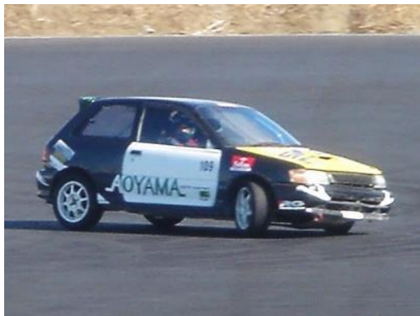
’06春合宿(関越SL) ジムカーナ練習車としても使用した。LSD入りT/Aと荷重移動の習熟に重宝。
