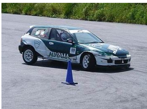
’07全関東G(浅間台) 音量規制によりバイク用マフラー装備。位置の変わった排気管で燃料トラブル。
